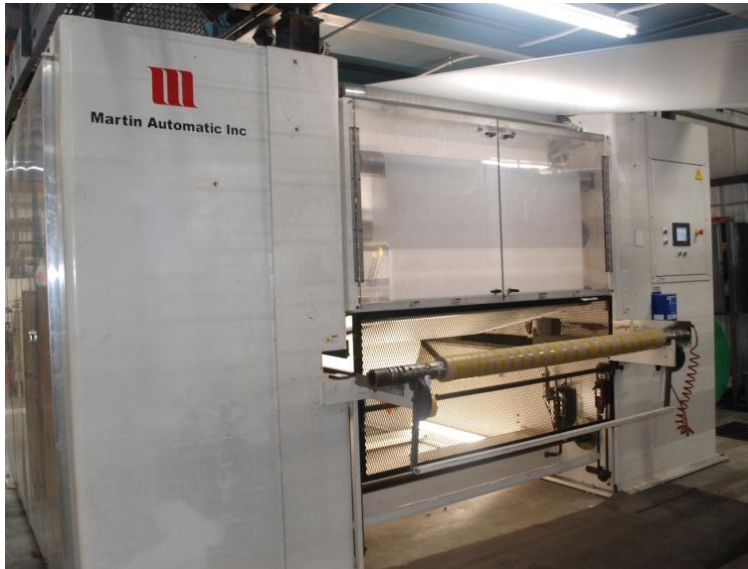
图: Acucote 公司最新的 RMAP 不停机自动收卷机来自马汀自动化科技公司, 可进行涂硅的薄膜, 纸张和纸板的收卷, 更可支撑涂布生产线的干燥设备
