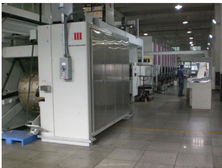
图2：马汀公司RMAP不停机放卷机安装在金鹏印务现有的博斯特凹印生产线上
