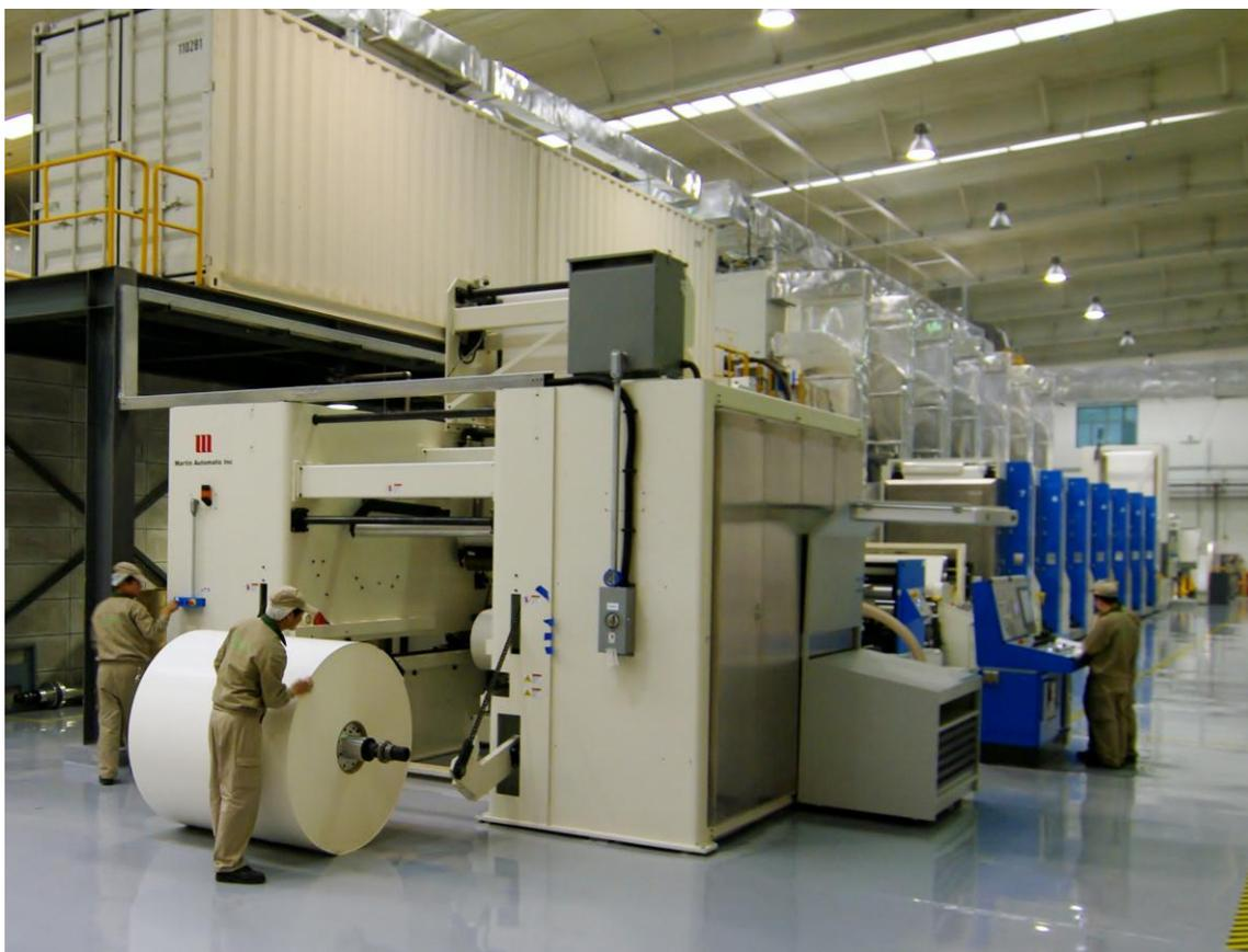
纷美包装安装的马丁自动科技 RMAP 全自动收卷机，可以自动地卸下收卷完成的纸卷，这个人性化的操作设计，使得操作人员的工作绝对安全且便利。
