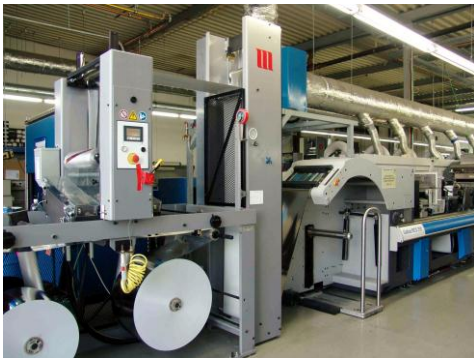
图说: GEWA 公司捷拉斯 RCS330 印刷机配备了马汀 MBSC 自动对接放卷机
