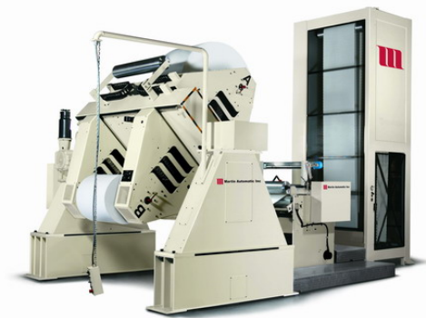
图 2：马汀 MTB 不停机收卷设备
