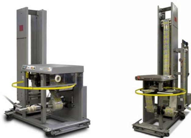
马汀自动科技为台湾客户的 Sanjo 印刷机量身定制的 STS 型对接式不停机自动放卷机及 STR 型旋转式不停机自动收卷机
